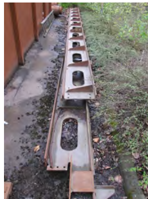
Abb. 3: Kranträger, Grundwerkstoff G03, Foto: SLV Halle GmbH
