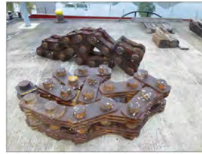
Abb. 1: Schleusenkette, Grundwerkstoff G01, Foto: SLV Halle GmbH
