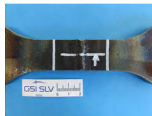
Abb. 17: Dauerschwingprobe FAT 90, Foto: SLV Halle
