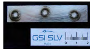
Abb. 11: Funkenerosionsprüfung, 3-fach abgefunkte Probe, Foto: SLV Halle
