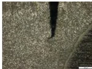
Abb. 22: Dauerschwingprobe FAT 112 mit Riss, Schliff, Vergrößerung, Foto: SLV Halle
