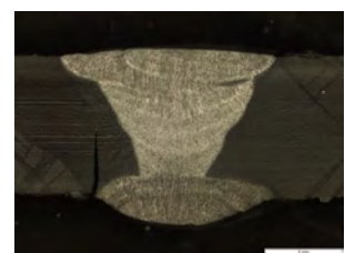
Abb. 18: Dauerschwingprobe FAT 90 mit Riss, Schliff, Foto: SLV Halle
