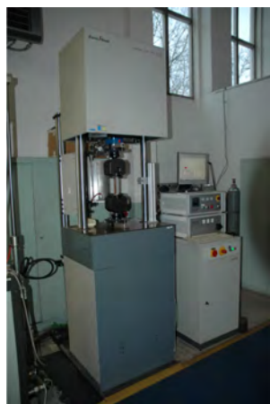
Abb. 15: Hochfrequenzpulsator Amsler HFP 5100, Foto: SLV Halle
