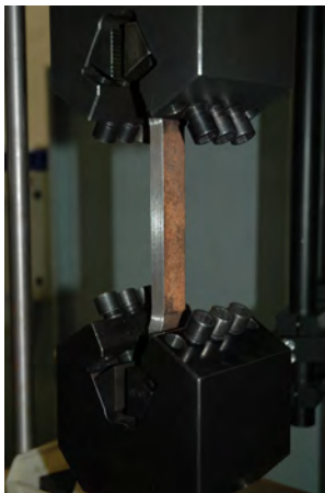
Abb. 14: Grundwerkstoffprobe, Foto: SLV Halle
