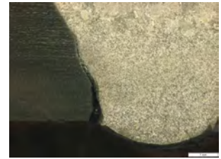
Abb. 26: Dauerschwingprobe FAT 71 mit Riss, Schliff, Vergrößerung, Foto: SLV Halle
